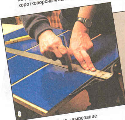
8 Следующая операция – вырезание стекла соответствующего формата. Стеклорезом, слегка нажимая на него,...
