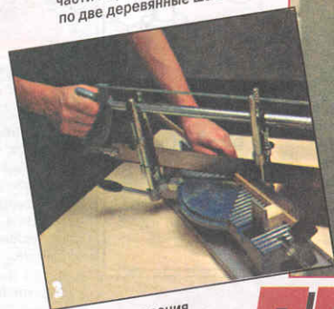
Для декорирования поверхностей распилов нарезают, используя стусло, планки прямоугольного сечения.
