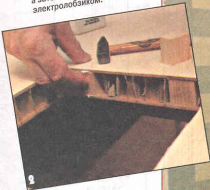
Чтобы стекла не провалились, в нижней части вырезов вклеивают по две деревянные шашки.
