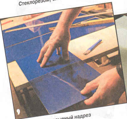
9 ...делают непрерывный надрез вдоль линии раскроя. Затем совмещают надрез с краем стола и осторожно ломают стекло.
